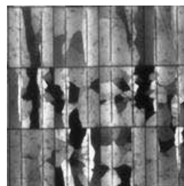
ELEKTROLUMINESZENZ-KAMERA ZEIGT MANGELHAFTE STELLEN
